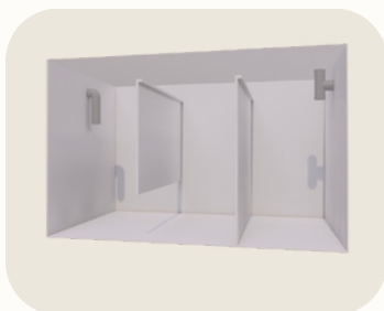
TRAMPA DE GRASA BAJO FREGADERO
